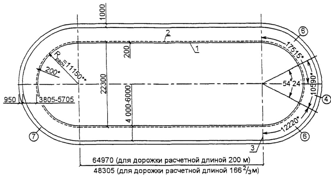
Б. С сопряжением прямых отрезков и поворотов при помощи переходной кривой (клотоиды)
