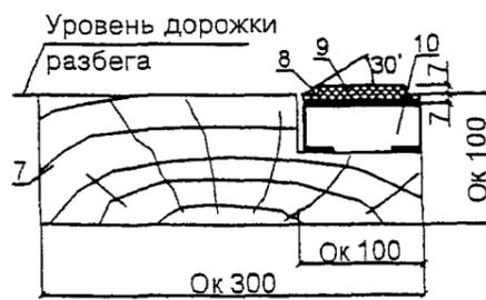
Примечания. 1. В целях исключения необходимости замены брусков отталкивания "пробками" (при чередовании видов прыжков) одинарное место предусматривается для прыжков в длину, а сдвоенное (при возможности на большее количество дорожек) место целесообразно предусматривать для тройных прыжков с размещением брусков отталкивания на различных от ямы приземления расстояниях (с учетом различных уровней физических возможностей спортсменов) от 7 до 13 м.
