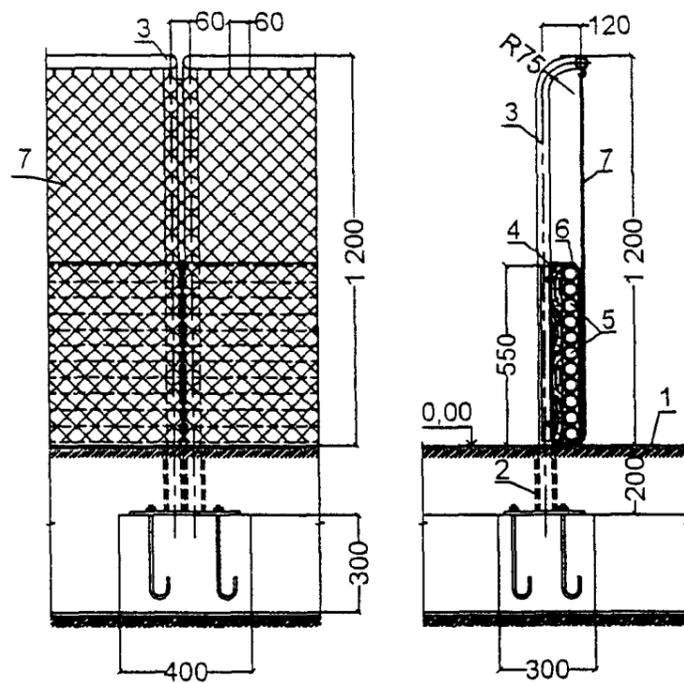
1 - пол; 2 - стакан; 3 - труба  $d = 42,3$  мм; 4 - щит из шпунтованных досок толщ. 32 мм, длиной 1000 мм; 5 - шланг резиновый Диаметр 50 мм; 6 - листовая резина 5 x 700 мм; 7 - стальная плетеная сетка
