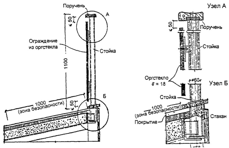
Шаг стоек принимают в зависимости от протяженности виража и с учетом размеров оргстекла, выпускаемого промышленностью. В зависимости от расположения мест для зрителей допускается замена оргстекла деревом (доски, фанера).
