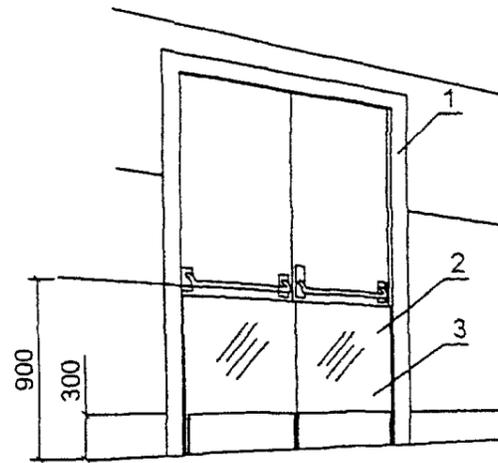
1 - наличник двери (устанавливается в одной плоскости со стеной зала); 2 - смотровая панель;
