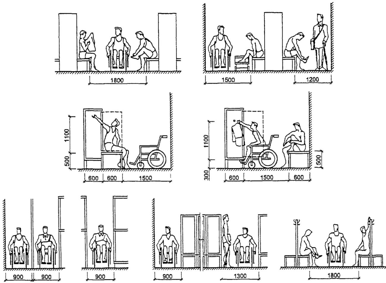
Рис. 6.2. Мебель и оборудование. Габаритные схемы
