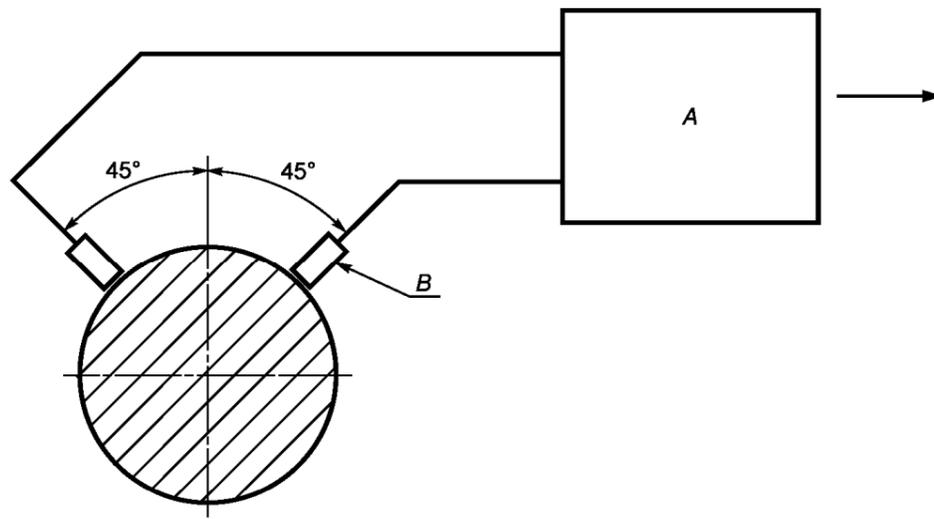
А - преобразователь; В - датчики
