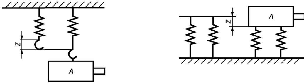
A - машина; Z - упругая деформация крепления
