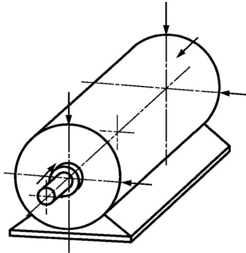
Рисунок 3 - Расположение датчиков на краях машины
