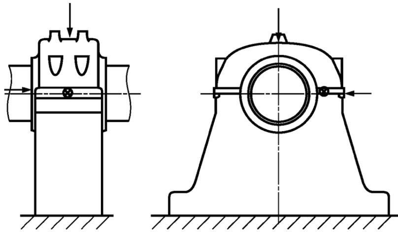
Рисунок 4 - Расположение датчиков у стояковых подшипников
