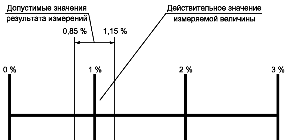
Рисунок 5. Пример неопределенности измерений несимметрии напряжений
