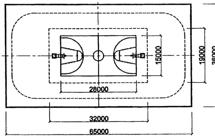
Рис. 3.17. РАССТАНОВКА ОБОРУДОВАНИЯ В ПОМЕЩЕНИЯХ
