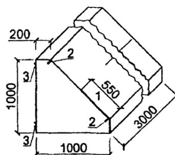
а - на легкометаллической основе с облицовкой из вспененного материала; б - выполненный целиком из вспененного материала; 1 - уплотненное покрытие; 2 - захватные устройства; 3 - соединительные детали
