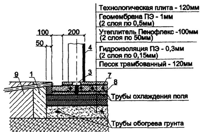
1 - подпорная стенка; 2 - грунт; 3 - закладная деталь борта; 4 - хоккейный борт; 5 - канал для отвода в канализацию; 6 - съемный щит; 7 - арматура диаметром 8 мм; 8 - арматура диаметром 12 мм; 9 - конструкция пола зала
