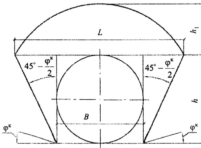
Рисунок 1. Схема для расчета высоты свода обрушения
