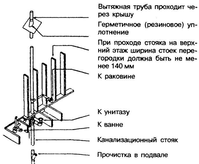
Рисунок 13-8. Прокладка канализационных труб в каркасе дома
