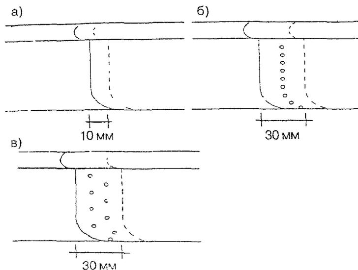
а - мягкая пайка или твердая сварка; б - мягкая сварка с одним рядом заклепок, в - мягкая сварка с заклепками, расположенными в шахматном порядке
