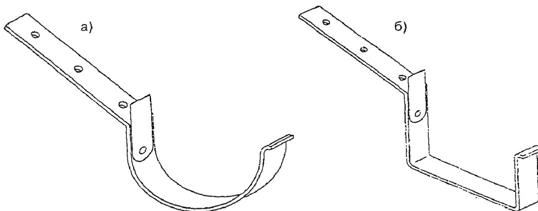
Рисунок 27. Медный кронштейн для полукруглого желоба (а) и для желоба коробчатого сечения (б)
