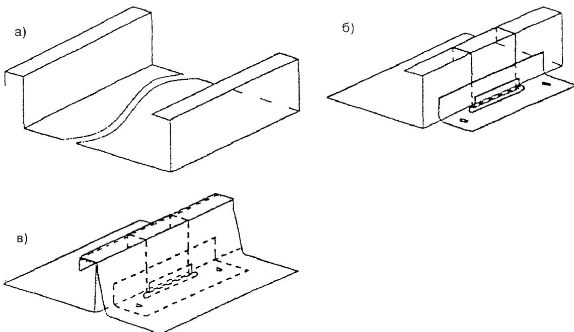
а - устройство кромок на листе; б - установка кляммера (скользящего кляммера) на основание и кромку листа; в - установка второго листа с отогнутой кромкой
