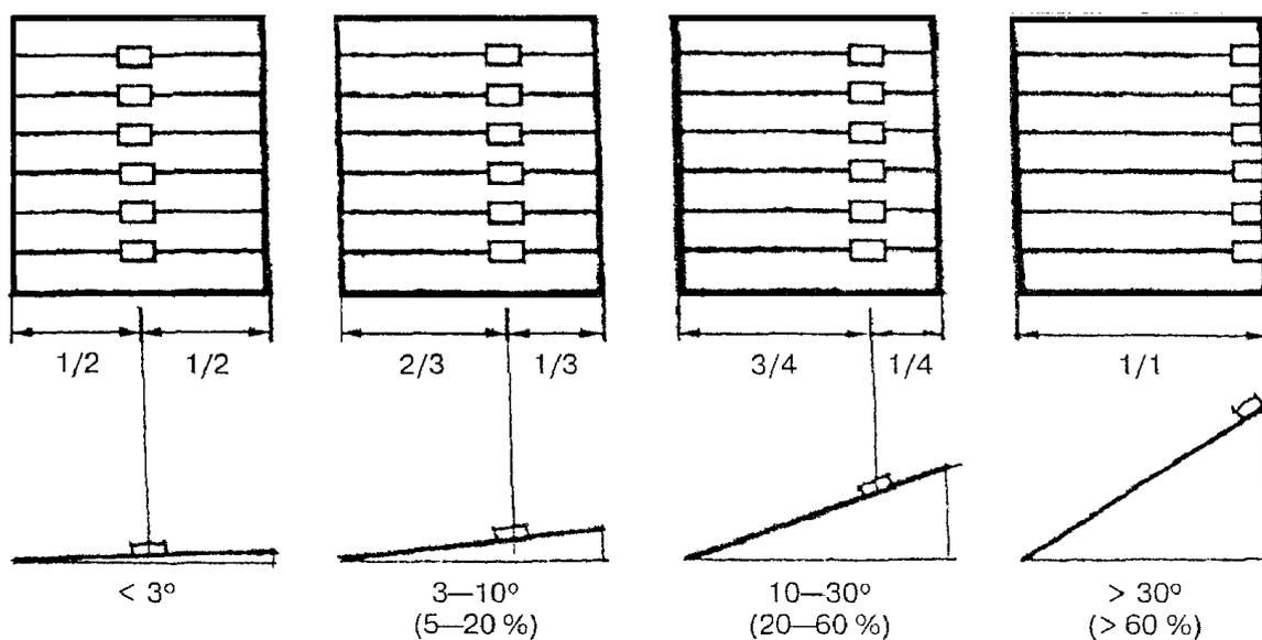
Рисунок 8. Места установки неподвижных кляммеров на кровле с длиной ската более 3 м в зависимости от уклона
