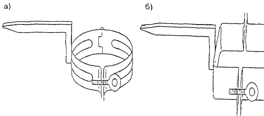
Рисунок 33. Крепежный кронштейн для круглой (а) и коробчатой (б) труб
