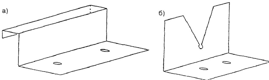
Рисунок 5. Неподвижные кляммеры, изготавливаемые механизированным (а) и ручным (б) способами
