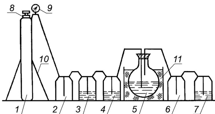
1 - баллон с аммиаком; 2 - промежуточная склянка; 3, 4 - поглотительные склянки; 5 - приемник; 6 - брызгоуловитель; 7 - склянка, для предотвращения попадания диоксида углерода из воздуха в приемник; 8 - редуктор; 9 - манометр; 10 - подставка; 11 - охлаждающая баня
