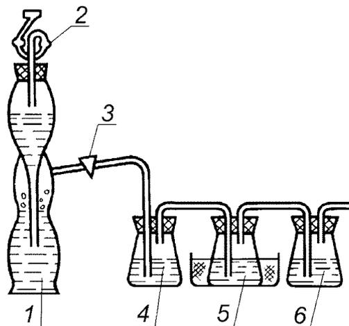
1 - аппарат Киппа; 2 - предохранительная воронка; 3 - кран;
