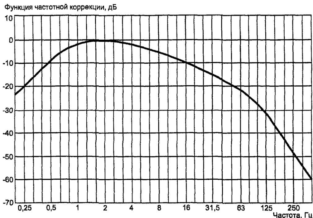
Рисунок А.1. Функция частотной коррекции  $W_m$
