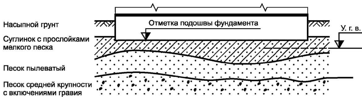
Рисунок Г.1. Схема фундамента и основания
