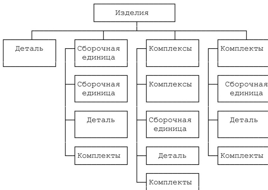
Рисунок А.1 - Виды и структура изделий по конструктивно-функциональным характеристикам
