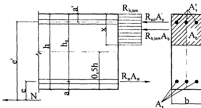
а - продольная сила  $N$  приложена между равнодействующими усилий в арматуре  $S$  и  $S'$ ; б - то же, за пределами расстояния между равнодействующими усилий в арматуре  $S$  и  $S'$
