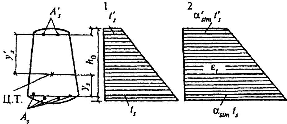
а - бетонного и железобетонного без трещин;
