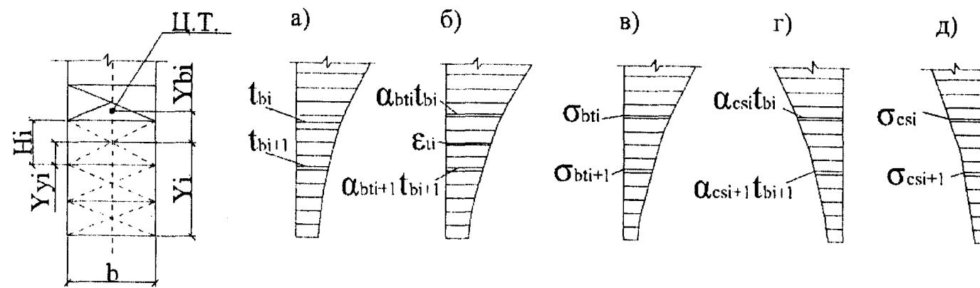
а - температуры бетона; б - деформации удлинения
