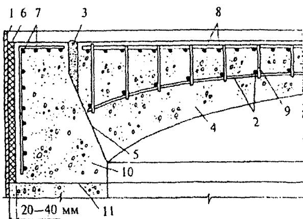
а - купола перекрытия с технологическими отверстиями из жаростойкого бетона; б - железобетонного купола покрытия с плоской верхней поверхностью из жаростойкого бетона;
