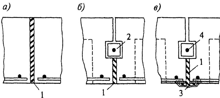
а - шов, заполненный шнуроным асбестом; б - то же, с бетонным бруском; в - то же, с металлическим компенсатором; 1 - шнуровой асбест, смоченный в глиняном растворе; 2 - бетонный бруск; 3 - компенсатор; 4 - стальной стержень диаметром 6 мм
