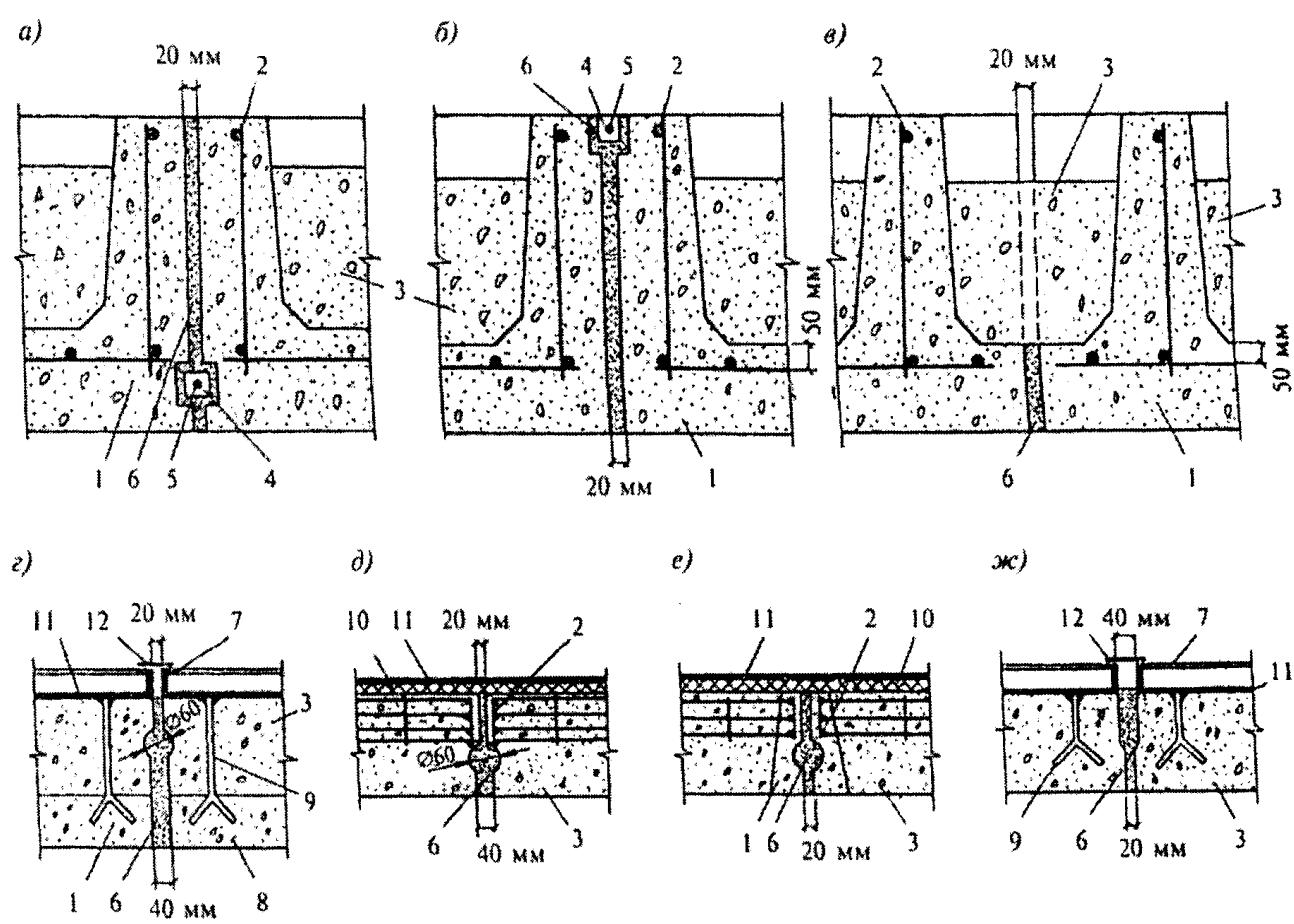
а - стык ребристых панелей в стенах; б - то же,
