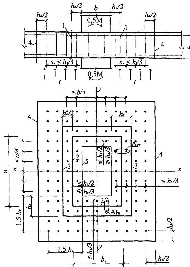
1 - расчетное поперечное сечение; 2 - контур расчетного поперечного сечения; 3 - граница зоны, в пределах которой учитывается поперечная арматура; 4 - контур расчетного поперечного сечения без учета в расчете поперечной арматуры; 5 - контур площадки приложения нагрузки
