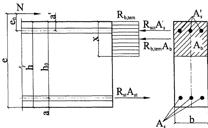
Рисунок 7.2. Схема усилий и эпюра напряжений в сечении, нормальном к продольной оси изгибающего железобетонного элемента, при расчете его по прочности
