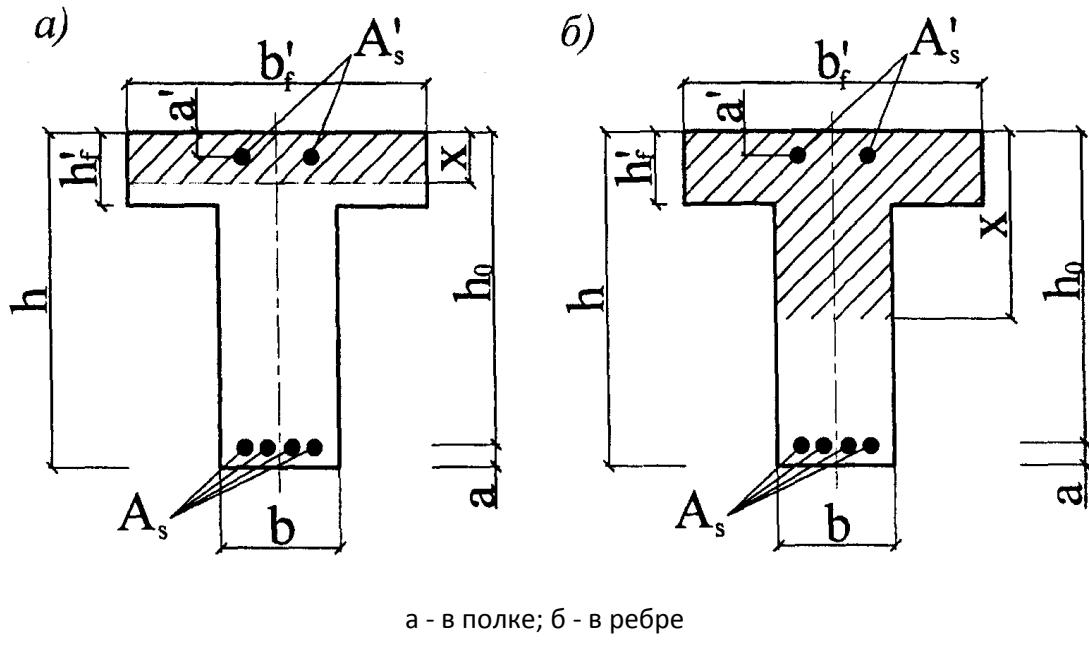
Рисунок 7.3. Положение границы сжатой зоны в сечении изгибающегося железобетонного элемента
