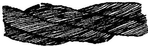
Рисунок 1. Обрывы и смещения проволок каната крестовой свивки
