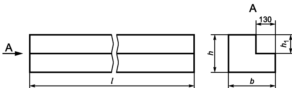
Рисунок 3 - Перемычка типа ПГ
