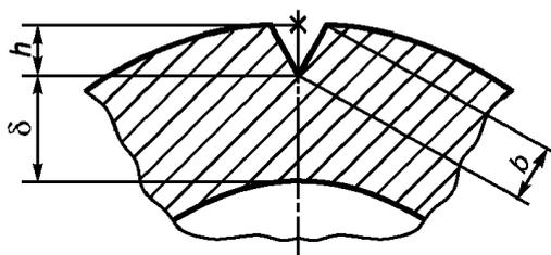
$b$  - ширина обработанной фрезерованием поверхности надреза;
