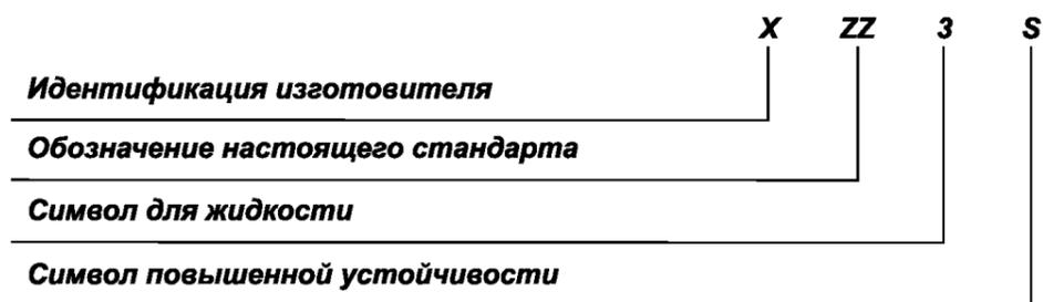
2. Маркировка оправы (корпуса) для защиты от грубодисперсных аэрозолей
