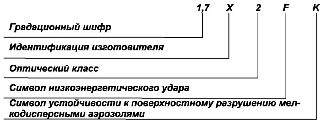
12. Защитное очковое стекло с функцией механической прочности, устойчивости к адгезии расплавленного металла, устойчивости к проникновению
