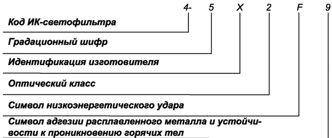
7. Светофильтры для сварки и других тепловых процессов с усиленным отражением
