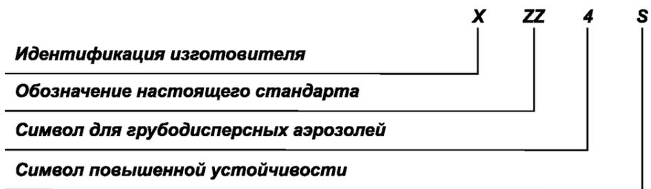
Примечание. На месте символов 3 и 4 в вышеприведенных примерах должны использоваться символы для обозначения оправ (корпусов) с защитой от газа и мелкодисперсных аэрозолей - 5, дуги короткого замыкания - 8 и расплавленного металла и горячих тел - 9.
