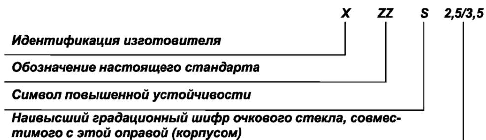
Примечание. Эта маркировка применима к закрытым очкам или оправам (корпусам), защитным лицевым щиткам, предназначенным для использования с УФ-светофильтром (с хорошей цветопередачей или без хорошей цветопередачи) до градационного числа 2,5 или 3,5.
