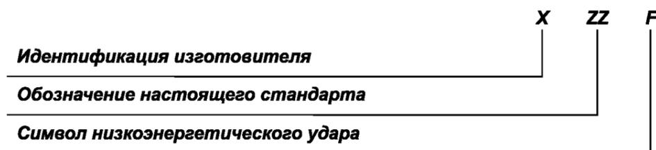
Примечание. На месте символа F в вышеприведенном примере символ B применим для маркировки оправы (корпуса), используемой для защиты от высокоскоростных частиц со средней энергией удара, а символ A - для маркировки оправы, используемой для защиты от высокоскоростных частиц с высокой энергией удара. Кроме того, если оправа (корпус) предназначена для защиты от высокоскоростных частиц при экстремальных температурах, за символом удара следует буква T, т.е. FT, BT или AT.
