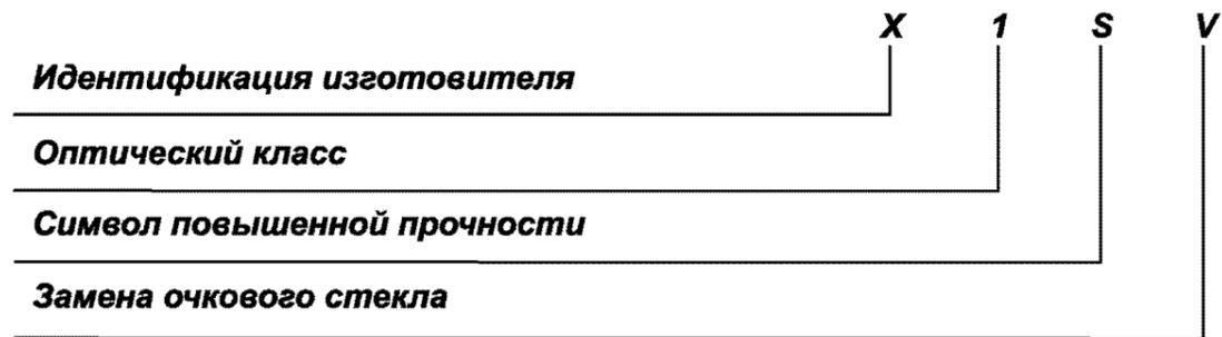
10. Защитное очковое стекло без фильтрующего эффекта и с самым высоким значением механической прочности при экстремальных температурах
