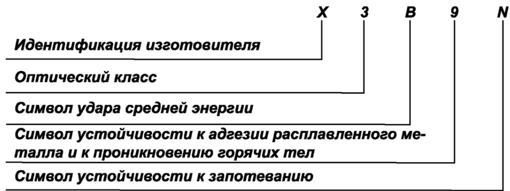
13. УФ-светофильтр с функцией механической прочности, устойчивый к поверхностному разрушению мелкодисперсными аэрозолями и запотеванию
