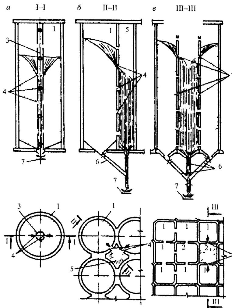
а - через разгрузочную трубу (I-I); б - через звездочку (II-II); в - через внутренний силос (III-III)
