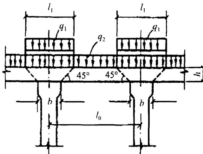
$q_1$  - нагрузка от стены силоса;  $q_2$  - нагрузка от дна (воронки);  $l_1$  - расчетная длина опирания стены силоса на балку;  $h$  - высота балки;  $b$  - ширина оголовка колонн;  $l_0$  - расстояние между осями колонн
