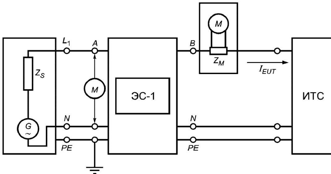
$G$  - источник электропитания;  $Z_s$  - внутреннее полное сопротивление источника электропитания;
