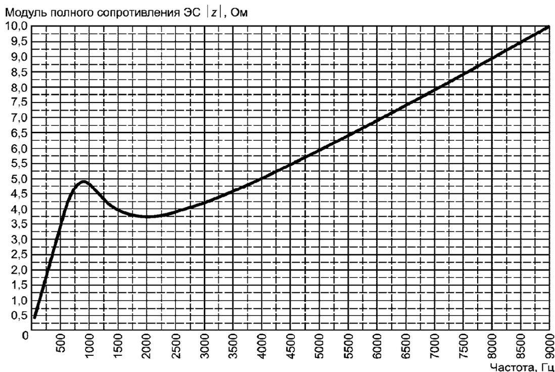
Рисунок В.5 - Модуль полного сопротивления эквивалента сети
