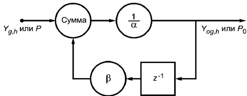
$z^{-1}$  - задержка, соответствующая длительности временного интервала измерения;  $\alpha$ ,  $\beta$  - коэффициенты фильтра, приведенные в [таблице 2](#)
