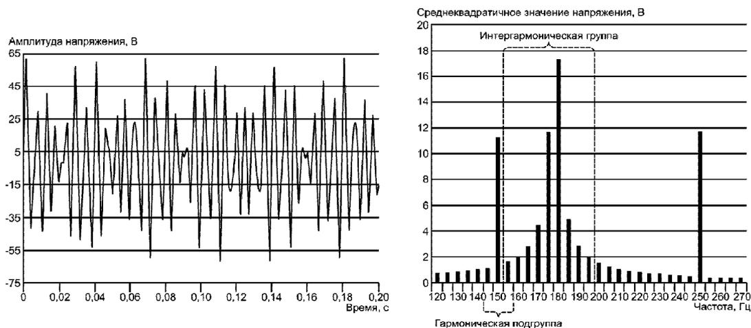
Рисунок С.4 - Передаваемый сигнал на частоте 178 Гц совместно с третьей и пятой гармониками
