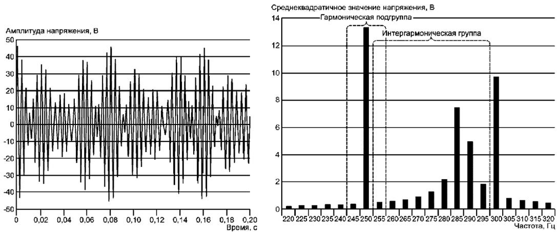
Рисунок С.5 - Интергармоника на частоте 287 Гц совместно с пятой и шестой гармониками
