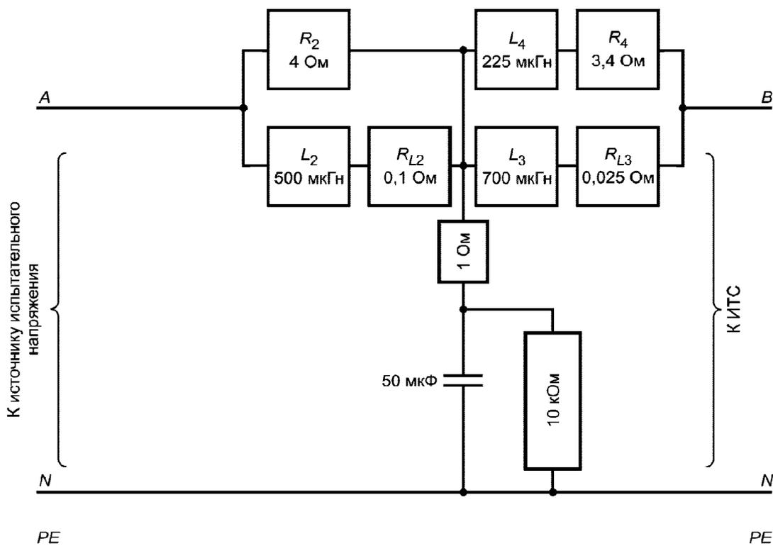
Рисунок В.4 - Эквивалент сети для испытаний ТС
