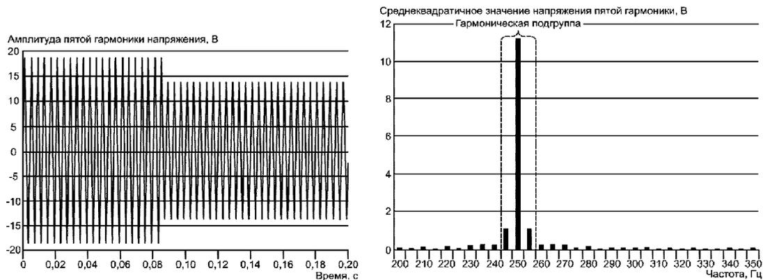
Рисунок С.2 - Колебания напряжения пятой гармоники
