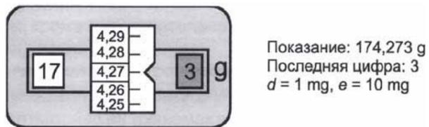
Рисунок 4. Пример дополнительного показывающего устройства
