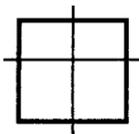
Указывают состояние устройства автоматической установки нуля или устройства слежения за нулем:
