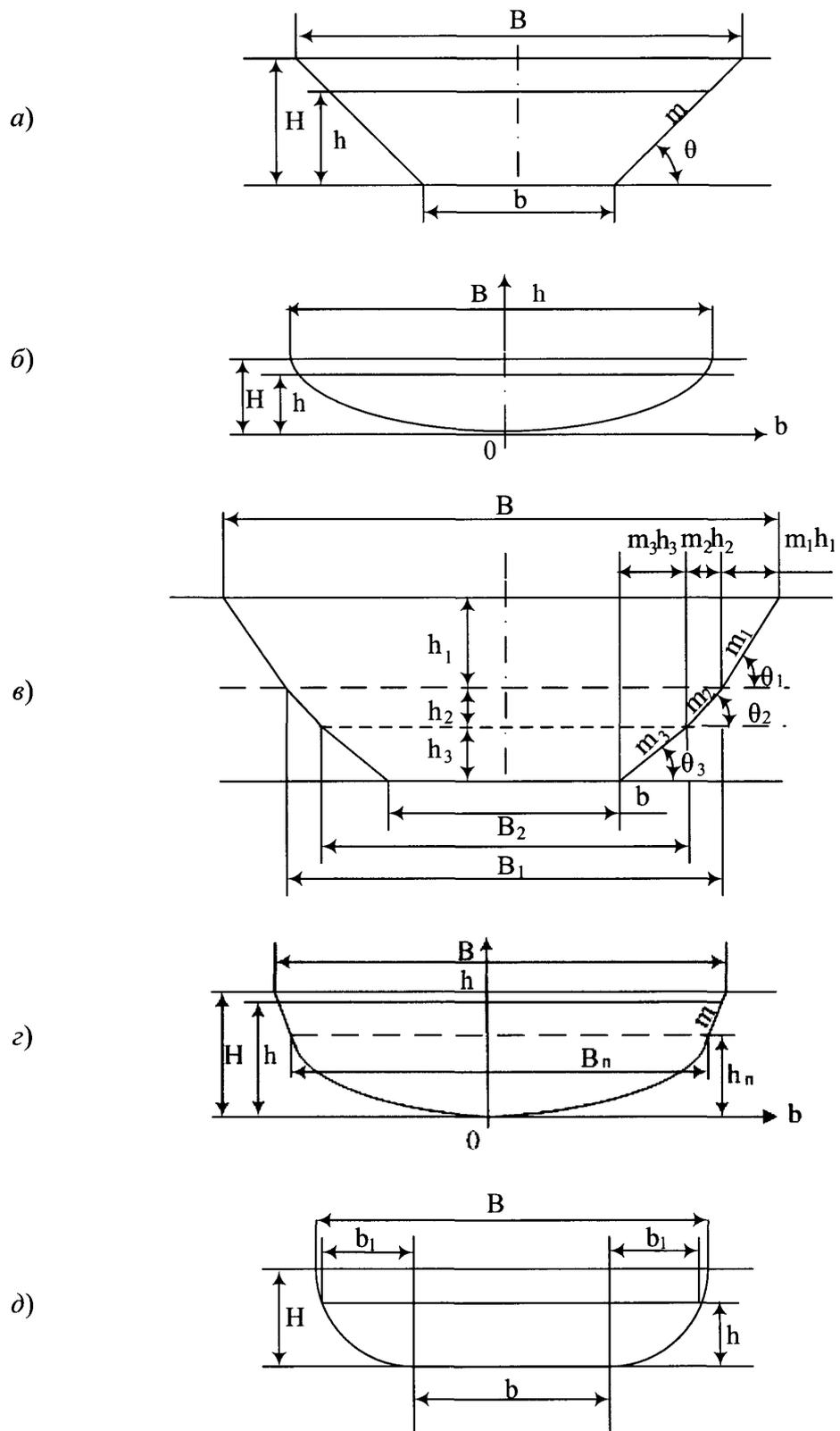
а - трапецидальная; б - параболическая; в - полигональная; г - комбинированная; д - параболическая с донной вставкой
