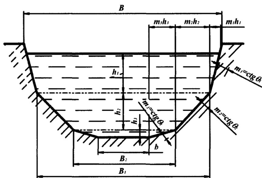
$b$  - ширина канала по дну,  $B$  - ширина по верху,  $B_1$  - ширина канала у подножья верхних откосов,  $m$ ;  $B_2$  - ширина канала у подножья средних откосов;  $h_1$  - глубина верхней части канала без учета запаса превышения бровки над уровнем воды,  $m$ ;  $h_2$  - глубина средней части канала,  $m$ ;  $h_3$  - глубина донной части канала,  $m$ ;  $m_1$  - заложение верхних откосов;  $m_2$  - заложение средних откосов;  $m_3$  - заложение донных откосов.
