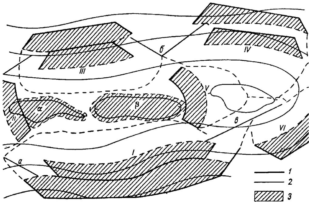
1 - земляные водоудерживающие валы; 2 - водоперехватывающие и направляющие валики; 3 - площади лиманного орошения; прерывистые линии - границы затопления; I - VI - секции лиманов;  $\alpha$ ,  $\beta$  - замкнутые естественные понижения; а, б, в - перехватывающие и водонаправляющие валики
