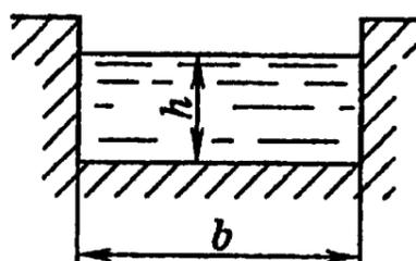
$b$  - ширина канала по дну,  $h$  - глубина воды в канале
