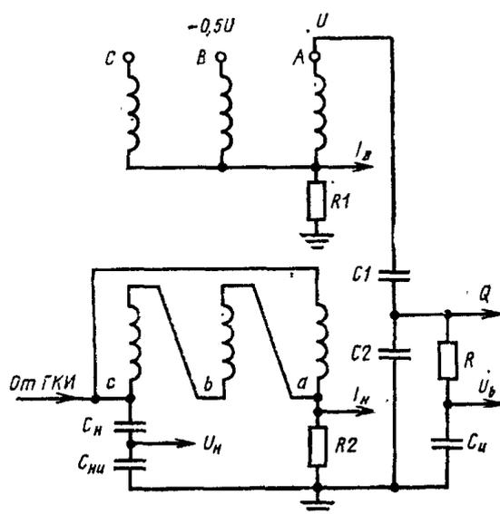
$C_1$  и  $C_2$  - емкости ввода высшего напряжения испытуемого трансформатора;  $C_H$  - емкость делителя низшего напряжения;
