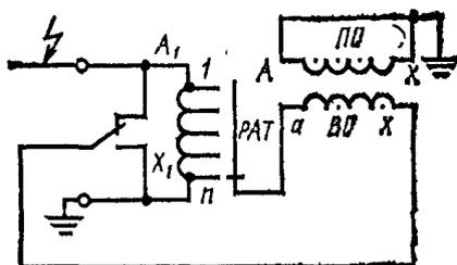
PAT - регулировочный автотрансформатор
