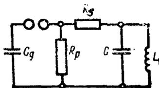
$C_g$  - главная емкость генератора импульсных напряжений;  $C = C_t + C_c + C_d$  - сумма емкостей делителя напряжения ( $C_d$ ), емкости для регулирования фронта импульса ( $C_c$ ) и емкости испытываемого объекта ( $C_t$ );
