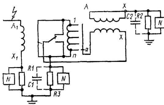
R3 - включается при наличии выводов концов обмотки PO
