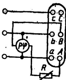
R - регулируемый резистор;  $P_\phi$  - фазометр;
