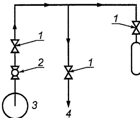
1 - вентиль; 2 - шаровой вентиль; 3 - зонд; 4 - сброс
