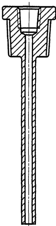
Рисунок 3. Зонд в виде прямой трубки
