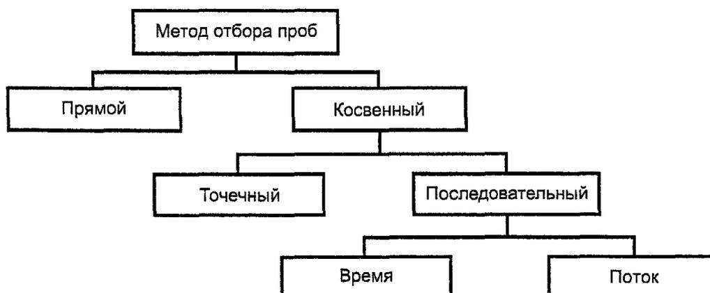
Рисунок 1. Схема прямого и косвенного методов отбора проб
