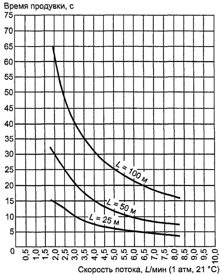
Рисунок G.6. Время продувки как функция скорости потока (внутренний диаметр трубки - 5 мм)
