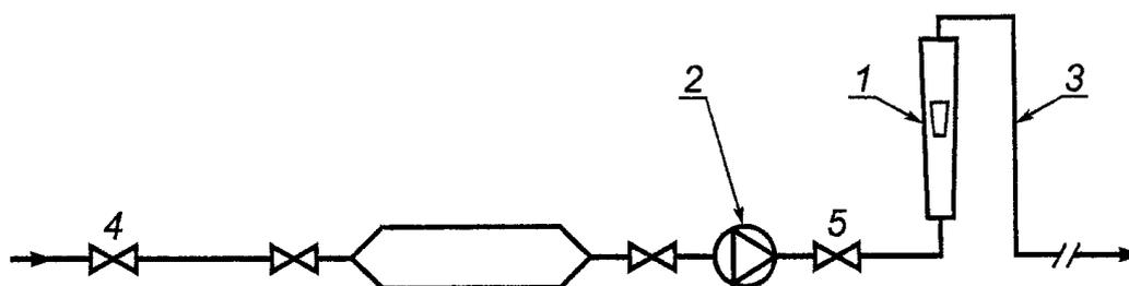
1 - ротаметр; 2 - диафрагменный насос (взрывобезопасный);
