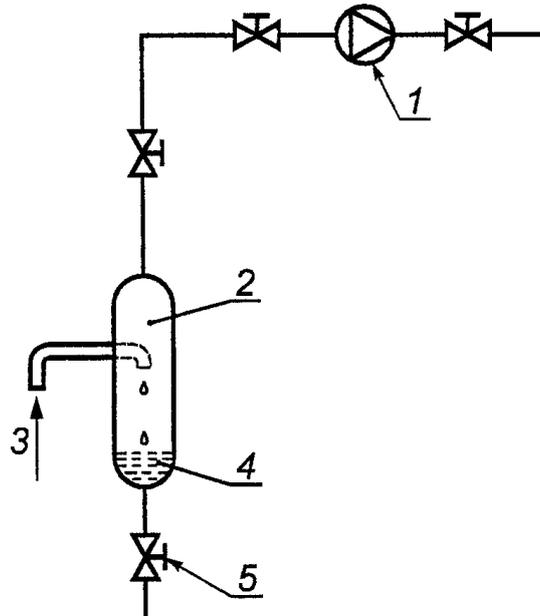
1 - редуктор давления; 2 - коллекторная емкость; 3 - газ из газопровода; 4 - конденсат; 5 - продувочный вентиль
