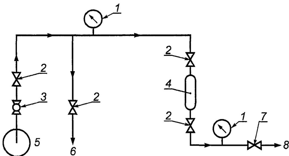
1 - манометр; 2 - вентиль; 3 - шаровой вентиль;
