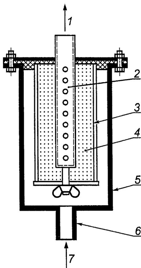
1 - выход газа; 2 - трубка с четырьмя рядами отверстий;
