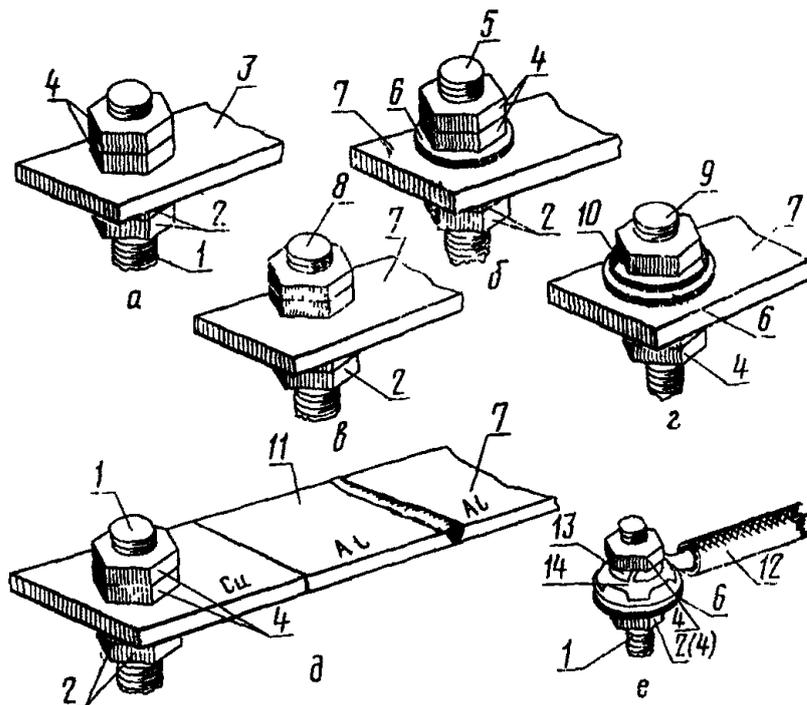
а - проводник из меди, твердого алюминиевого сплава или алюминия с защитным металлическим покрытием рабочей поверхности; б, в, г - алюминиевый проводник; д - алюминиевый проводник через переходную медно-алюминиевую пластину; е - однопроволочная (многопроволочная) жила провода кабеля сеч. 10 мм<sup>2</sup> с изгибанием в кольцо.
