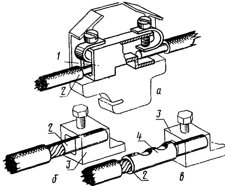
а, б - однопроволочная (многопроволочная, сплавленная в монолит) жила; в - многопроволочная жила, оконцованная кабельным наконечником.
