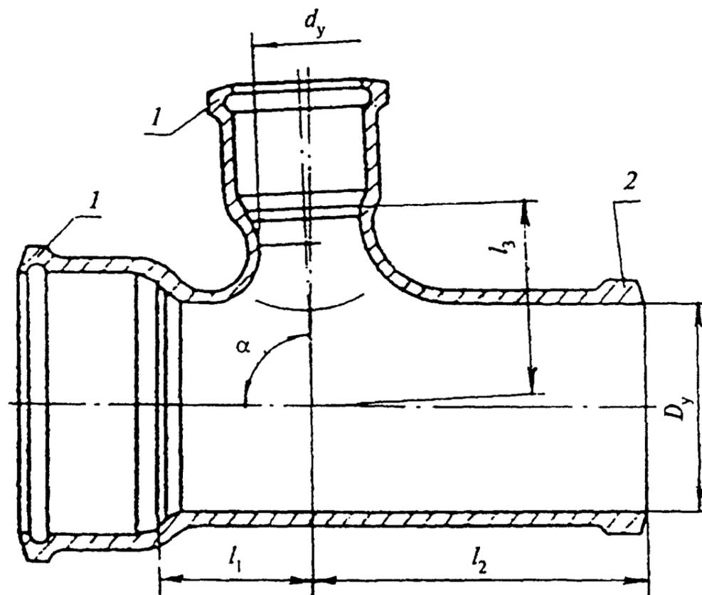
$\alpha = 87^{\circ}30' \pm 1^{\circ}30'$ ; 1 - раструб типа I; 2 - хвостовик
