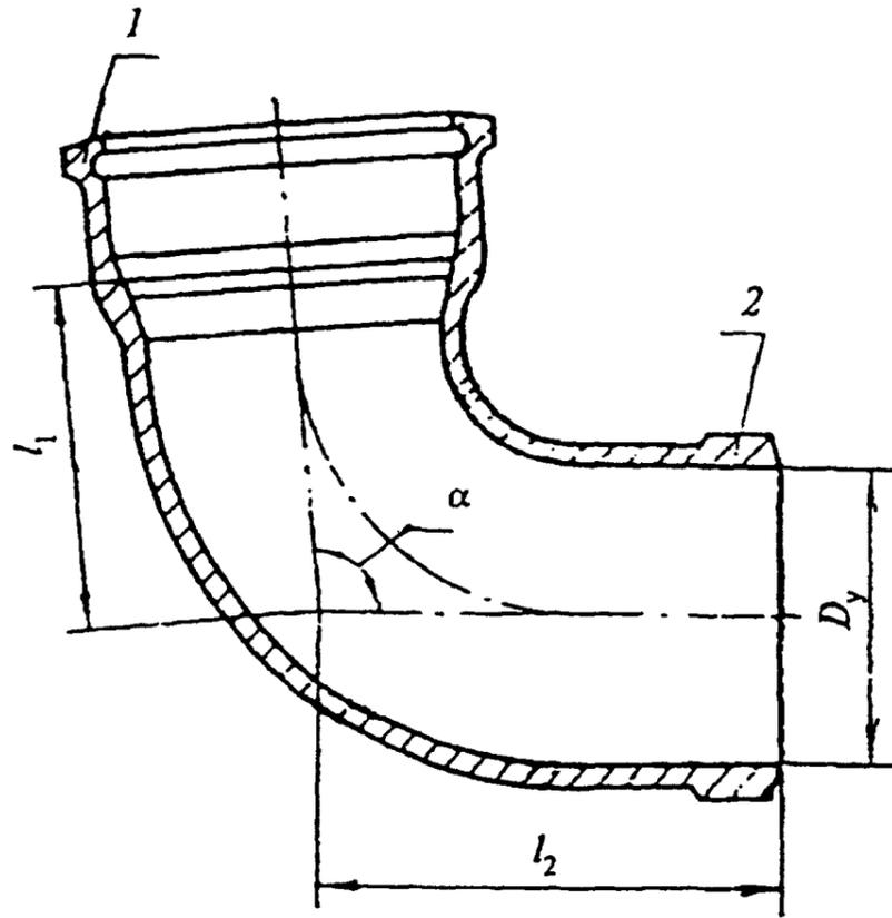
$\alpha = 92^{\circ}30' \pm 1^{\circ}30'$ ; 1 - раструб типа I; 2 - хвостовик
