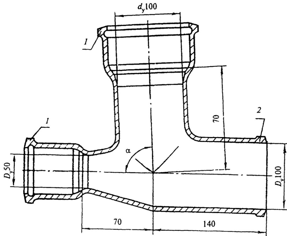
$\alpha = 87^{\circ}30' \pm 1^{\circ}30'$ ; 1 - раструб типа I; 2 - хвостовик
