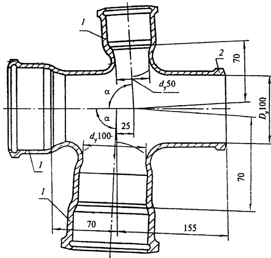
$\alpha = 87^{\circ}30' \pm 1^{\circ}30'$ ; 1 - раструб типа I; 2 - хвостовик
