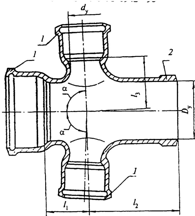
$\alpha = 87^{\circ}30' \pm 1^{\circ}30'$ ; 1 - раструб типа I; 2 - хвостовик
