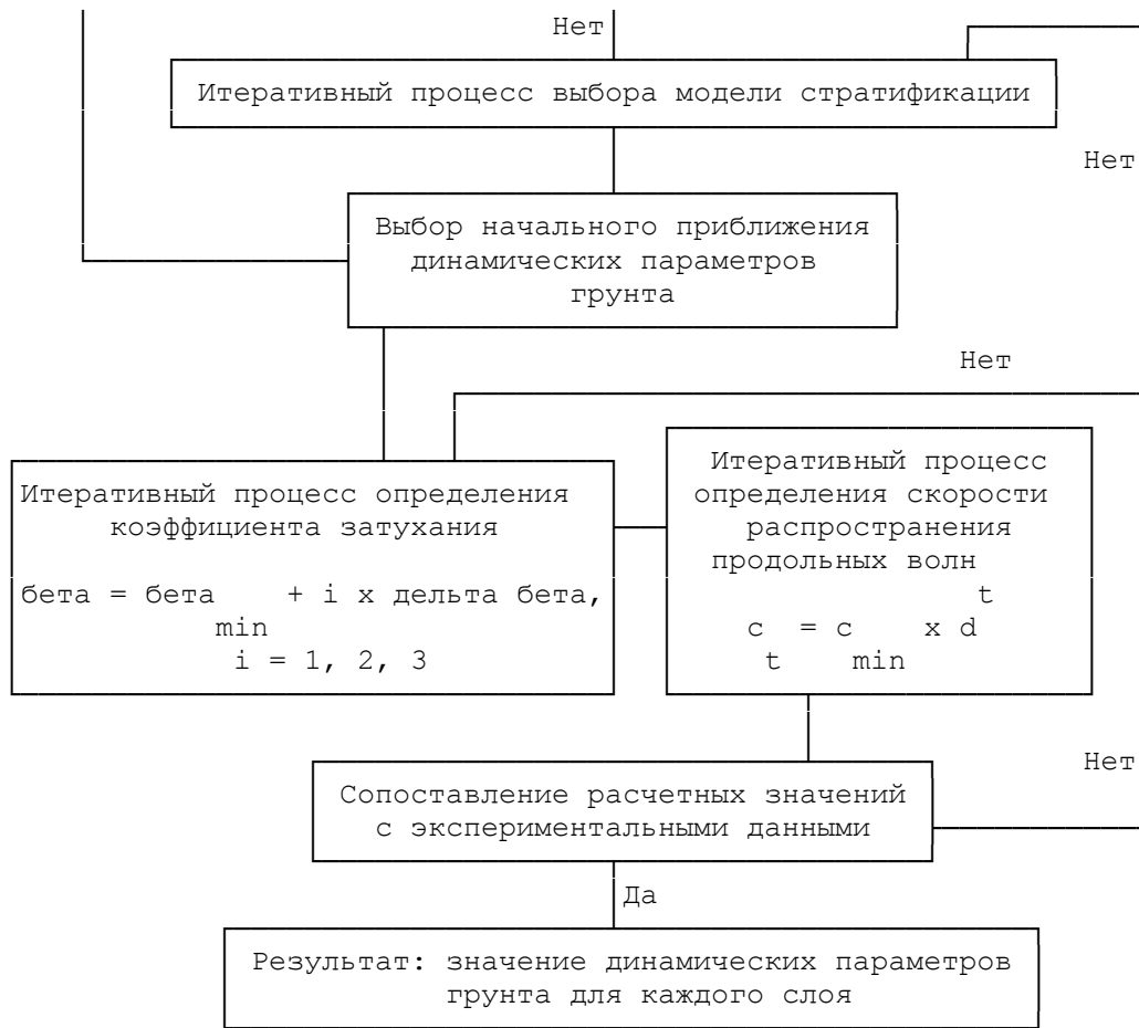
Рисунок 4.1. Блок-схема реализации алгоритма определения динамических параметров грунта. "Да" и "Нет" означают соответственно выполнение и невыполнение условий совпадения расчетных и измеренных данных
