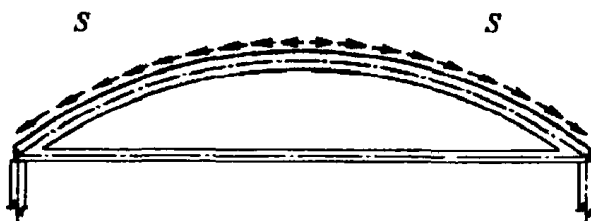
Рисунок 9.9. Схема передачи усилий с оболочки на диафрагму
