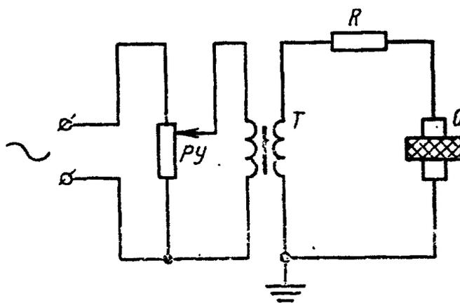
T - высоковольтный испытательный трансформатор;
