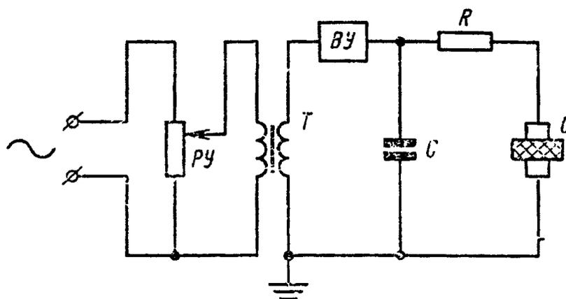
T - высоковольтный испытательный трансформатор;
