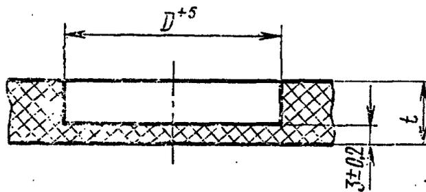
Трубчатый или цилиндрический образец
