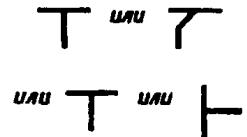
4. Графический излом линий электрической связи, линий групповой связи, провода, кабеля, шины:
