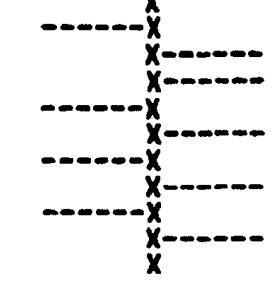
6. Графическое разветвление (слияние) линий электрической связи в линию групповой связи, разводка жил кабеля или проводов жгута
