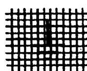
Электрическое соединение с корпусом
