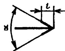
Примечание к пп. 3 - 6. Размеры стрелки должны быть в пределах  $l = 3 \dots 5$ , альфа =  $15^\circ \dots 30^\circ$ .
