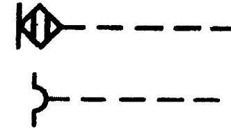
о) приводимый в движение с помощью электромагнитной защиты по типу перегрузки
