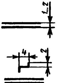
8. Линия механической связи со ступенчатым движением
