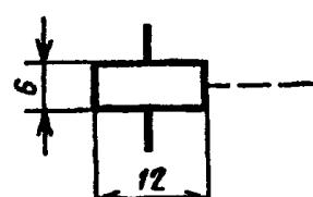
в) пневматический или гидравлический
