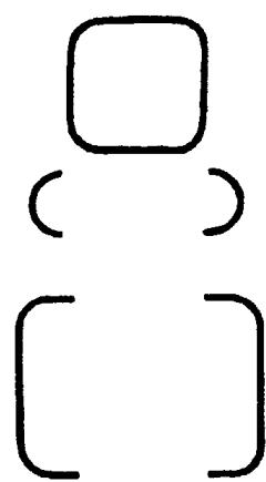
3. Линия для выделения устройств, функциональных групп, частей схемы
