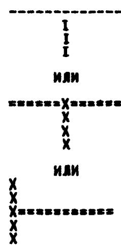
8. Графический излом линии электрической связи, линии групповой связи, провода, кабеля, шины:
