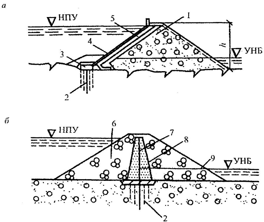
а - б - см. [таблицу 7](#); 1 - тело плотины из каменной наброски; 2 - цементационная завеса; 3 - бетонный зуб; 4 - железобетонный экран; 5 - подэкрановый слой; 6 - верховая призма; 7 - диафрагма; 8 - переходные слои; 9 - низовая призма
