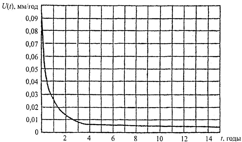
Рисунок Ж.5. Изменение средней скорости коррозии стальной диафрагмы в водно-грунтовой среде северной строительно-климатической зоны
