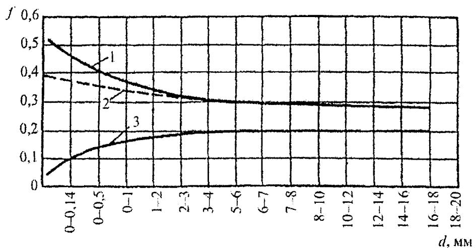
1 - грунт влажностью 2 - 7%; 2 - грунт влажностью 100%;
