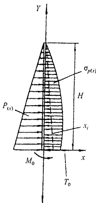
$P_{(x)}$  - расчетная нагрузка на диафрагму;
