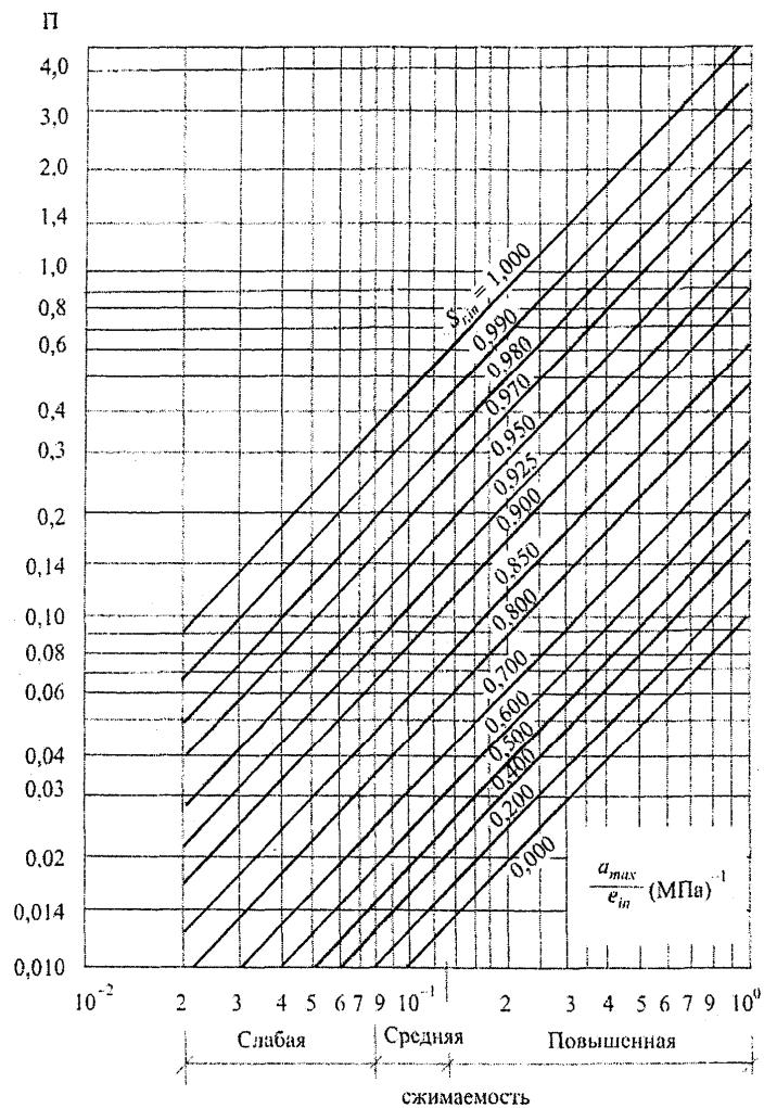
Рисунок А.2. Номограмма для определения параметра  $\Pi$
