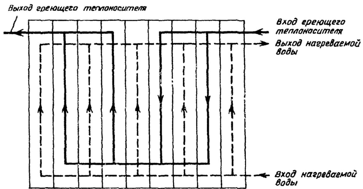
Рис. 2. Несимметричная компоновка пластинчатого водоподогревателя, обозначение Сх(2 + 2)/5
