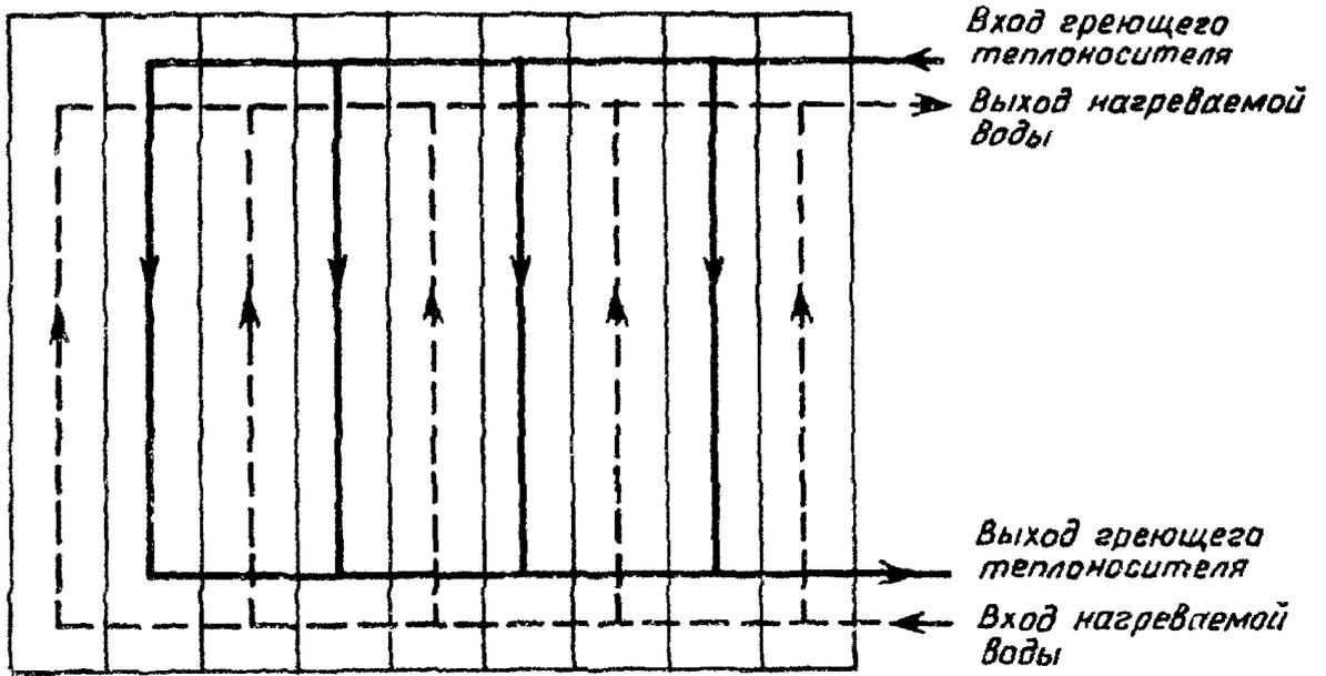
Рис. 1. Симметричная компоновка пластинчатого водоподогревателя, обозначение Сх4/5
