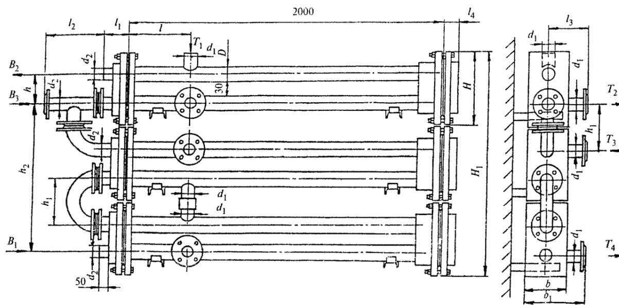
Рис. 6. Водоподогреватель блочного типа
