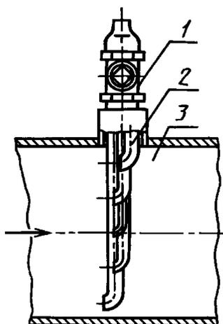
1 - вентиль; 2 - пробозаборная трубка;
