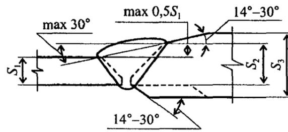
Г. Обработка стенки с толщиной  $S_3$  с наружной и внутренней стороны до размера  $S_2 \leq 1,5S_1$
