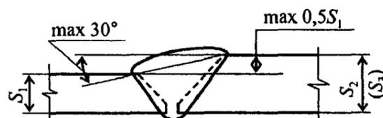
Б. Соединение  $S_2(S_3) / S_1 \leq 1,5$  без дополнительной
