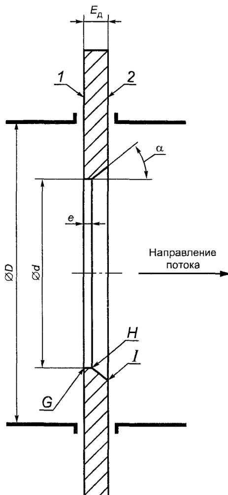
1 - входной торец диафрагмы; 2 - выходной торец диафрагмы
