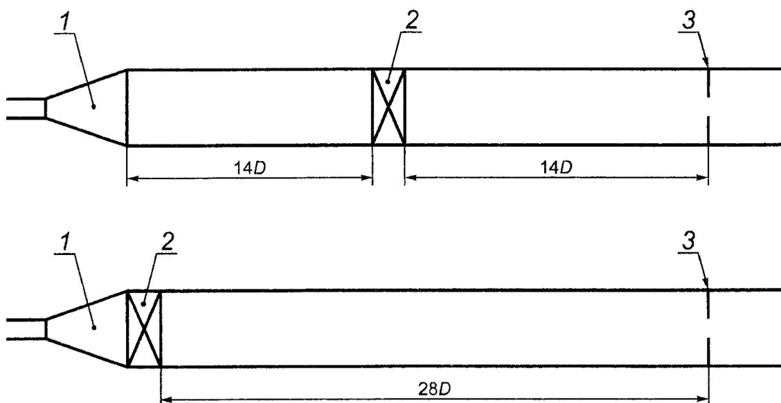
1 - диффузор; 2 - шаровой кран или задвижка; 3 - диафрагма
