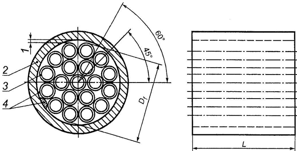
1 - минимизированный зазор; 2 - стенка ИТ; 3 - толщина
