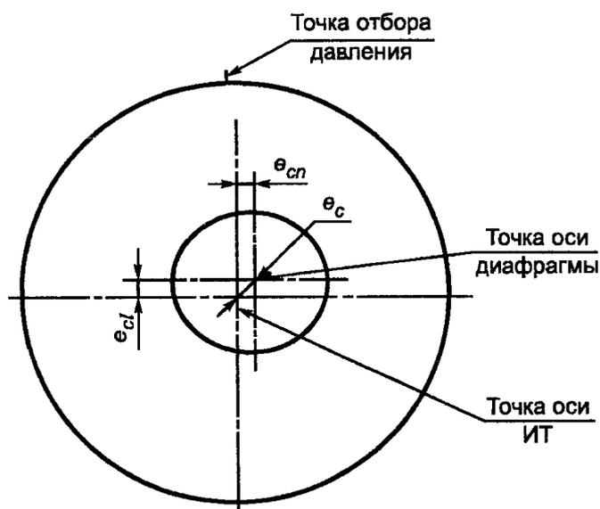
Рисунок 10. Параметры эксцентриситета установки диафрагмы
