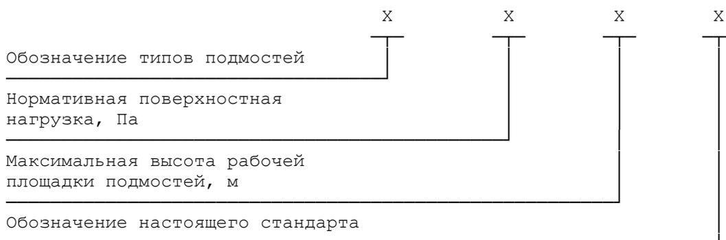
Пример условного обозначения подмостей передвижных сборно-разборных из плоских секций, с нормативным значением поверхностной нагрузки 2000 Па и высотой рабочего настила 4,0 м:
