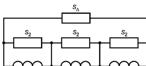
Рисунок 1 - Схема подключения фазных нагрузок
