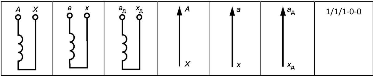
Схемы и группы соединений обмоток однофазных четырехобмоточных трансформаторов с двумя основными и дополнительной вторичными обмотками
