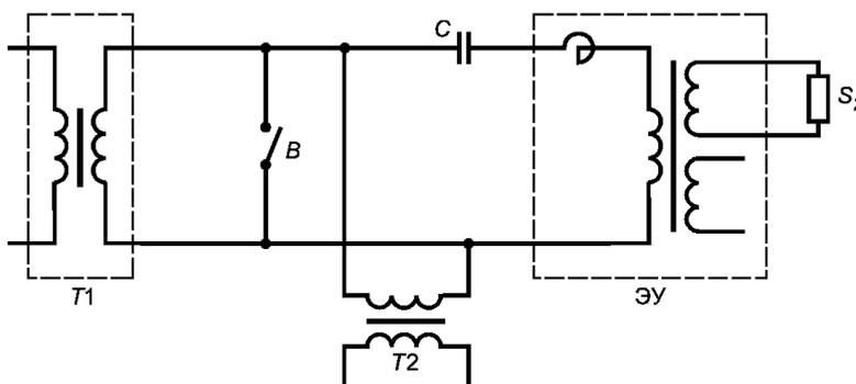
T1 - питающий трансформатор; С - конденсатор отбора мощности емкостного трансформатора; T2 - трансформатор напряжения
