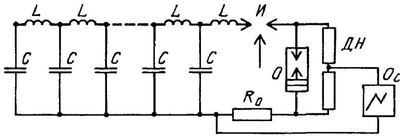
$C$ ,  $L$  - емкости и индуктивности генератора импульсов тока большой длительности соответственно;
