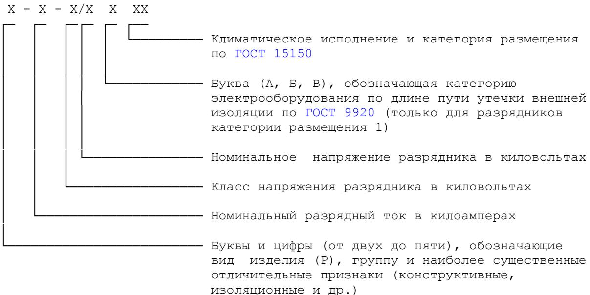
Пример условного обозначения разрядника вентильного серийного группы III на номинальный разрядный ток 5 кА, класс напряжения 110 кВ, номинальное напряжение разрядника 102 кВ, категории по длине пути утечки на 20% выше А, климатического исполнения У, категории размещения 1:
