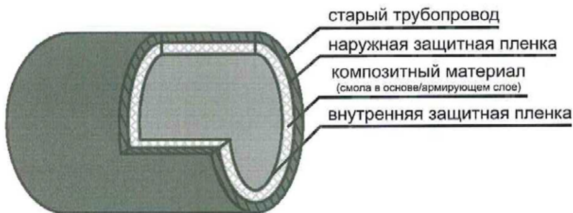
Рисунок 1 - Типовая конструкция гибкого полимерного рукава
