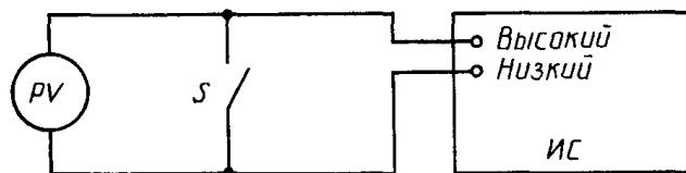
PV - вольтметр постоянного тока с входным сопротивлением не менее чем в 50 раз больше конечного значения наибольшего диапазона измерений (для уменьшения ошибки, обусловленной нагрузкой); S - выключатель;
