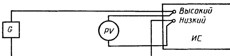
G - источник постоянного тока; ИС - испытуемое СИ;
