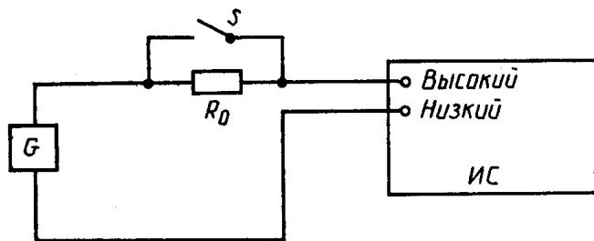
G - источник переменного напряжения (переменная частота, постоянная амплитуда); ИС - испытуемый ЦИП;
