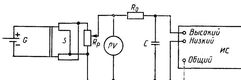
G - батарея; PV - вольтметр;  $R_0$  - резистор, сопротивление которого выбирают от 1 до 100 МОм
