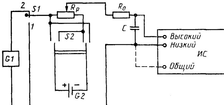
G1 - источник постоянного напряжения; ИС - испытуемое СИ;
