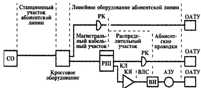
СО - станционное оборудование; ВЛС - воздушная линия связи; КЛ - кабельная линия; РШ - кабельный распределительный шкаф; РК - абонентская распределительная коробка; КЯ - телефонный кабельный ящик; ВЛС - воздушная линия связи; АЗУ - абонентское защитное устройство; ОАТУ - окончное абонентское телефонное устройство; - место стыка
