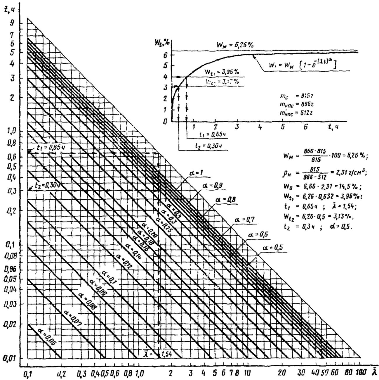
Черт. 1. Номограмма и пример расчета параметров пористости по кинетике насыщения материала жидкостью (непрерывный метод)
