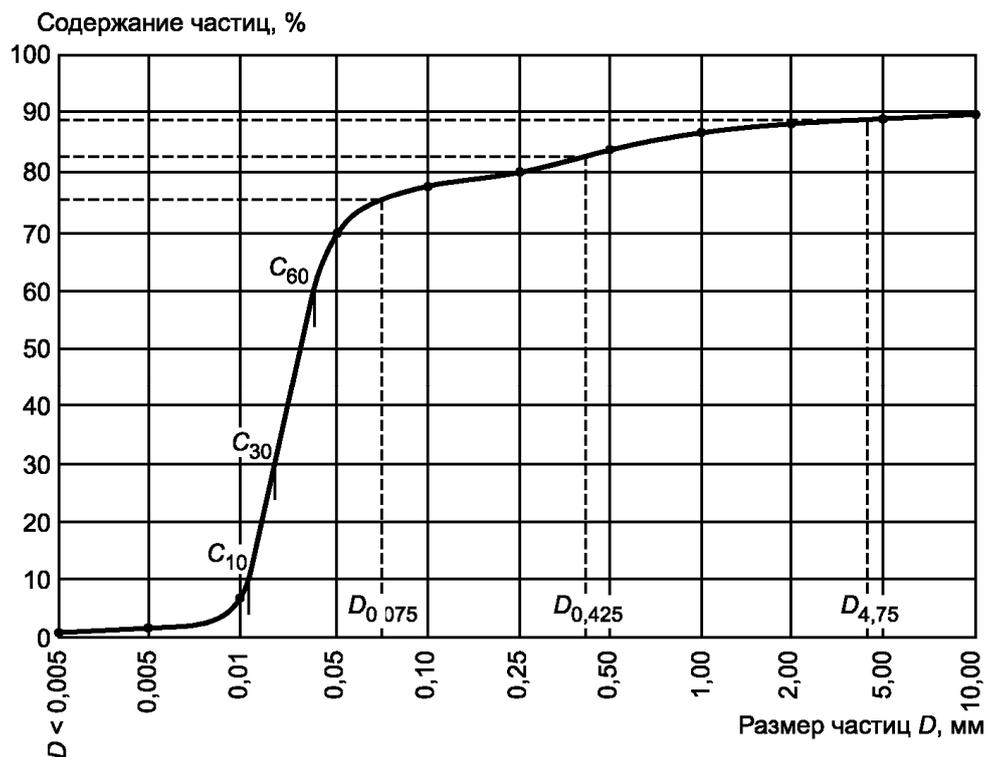
Рисунок Е.2. Кумулятивная кривая гранулометрического состава
