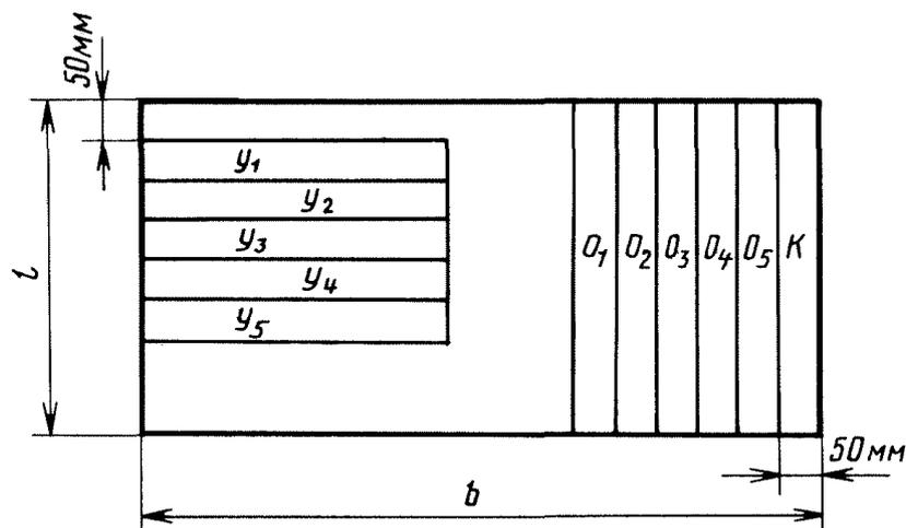
$y_1, y_2, y_3, y_4, y_5$  - уточные элементарные пробы;  $o_1, o_2, o_3, o_4, o_5$  - основные элементарные пробы;  $к$  - полоски ткани с кромкой;  $b$  - ширина ткани;  $l$  - длина точечной пробы, зависящая от зажимной длины элементарной пробы
