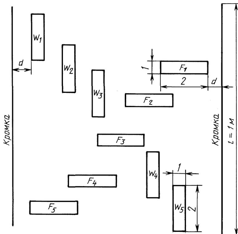
$W_1 - W_5$  - элементарные пробы по основе;  $F_1 - F_5$  - элементарные пробы по утку;  $d$  - расстояние от кромки до элементарной пробы, не менее  $1/10$  ширины ткани;  $l$  - длина точечной пробы;  $1$  - ширина элементарной пробы;  $2$  - длина элементарной пробы
