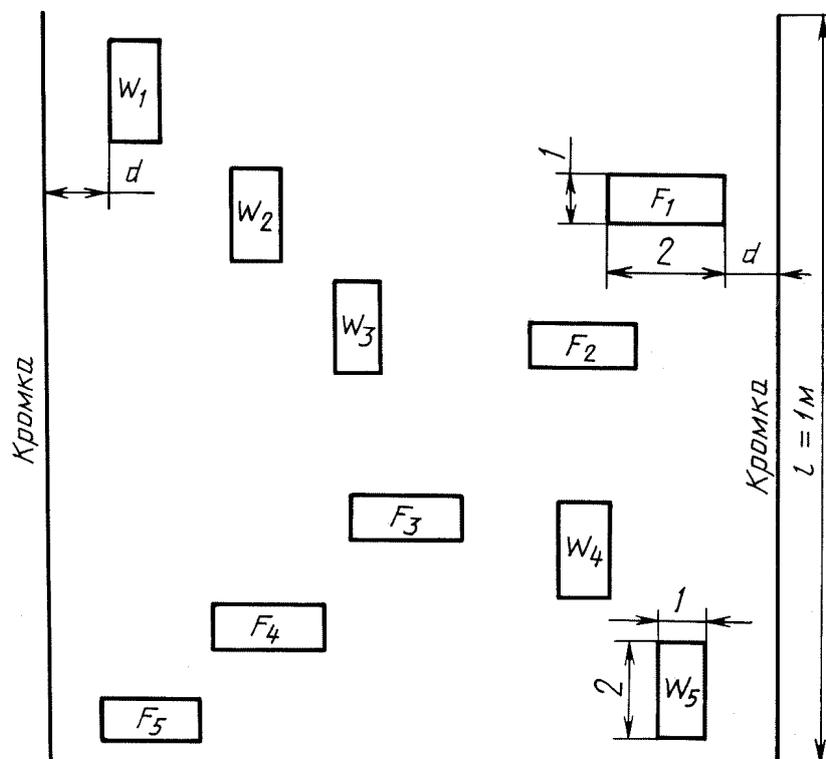
W<sub>1</sub> - W<sub>5</sub> - элементарные пробы по основе; F<sub>1</sub> - F<sub>5</sub> - элементарные пробы по утку; d - расстояние от кромки до элементарной пробы не менее 1/10 ширины ткани; l - длина точечной пробы; 1 - ширина элементарной пробы; 2 - длина элементарной пробы
